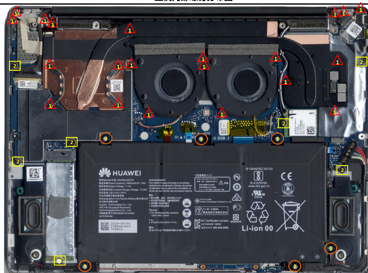
主机内部螺钉分布图
